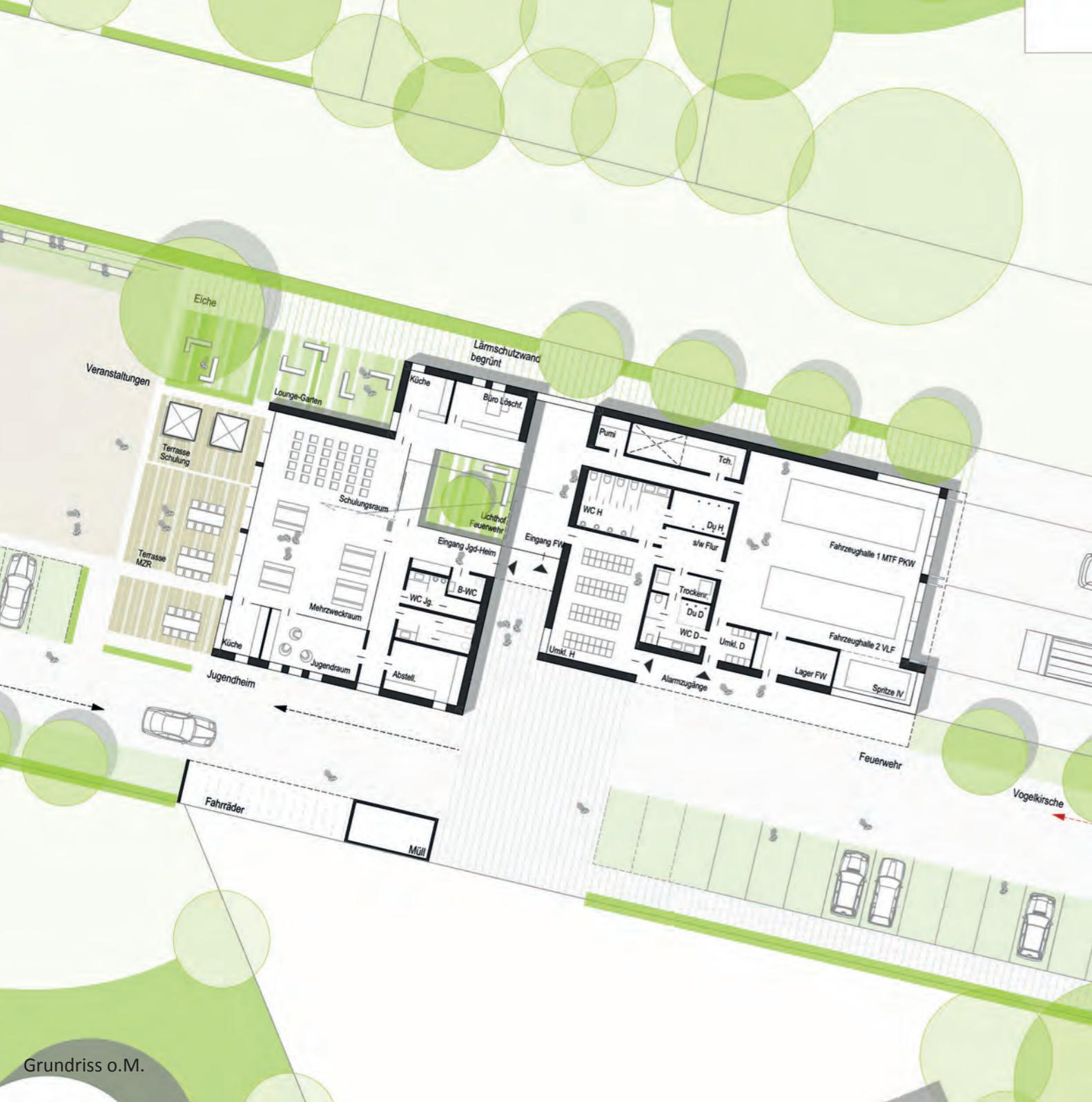
ist als Leimholzkonstruktion vorgesehen. Hier ist die gewünschte Raumhöhe in der Fahrzeughalle von 5,50 m gewährleistet. Der Dachraum des anschließenden Dachkörpers kann als Stauraum genutzt werden, der über eine Öffnung im Technikraum erschlossen werden kann. Der Innenbereich des Jugend- und Schulungsbereiches erhält Parkettflächen, die Technik- und Umkleieräume sowie die Nebenräume des Jugendheimes werden mit Betonwerkstein belegt. Die Fahrzeughalle erhält einen roten Rüttelklinker.
